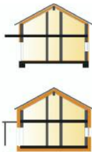
Der Wärmeschutz sollte idealerweise die gesamte Haushülle samt Sohlplatte umfassen. Passivhaus Institut
