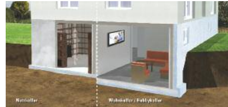
Durch eine wirksame Dämmung an den Kelleraußenwänden und unter der Bodenplatte werden Wärmebrücken minimiert und die Energieeffizienz gesteigert. Bürkle
