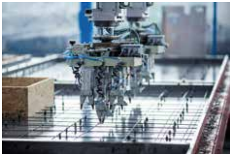
4. Einlegen der Bewehrung auf dem Schalungstisch
