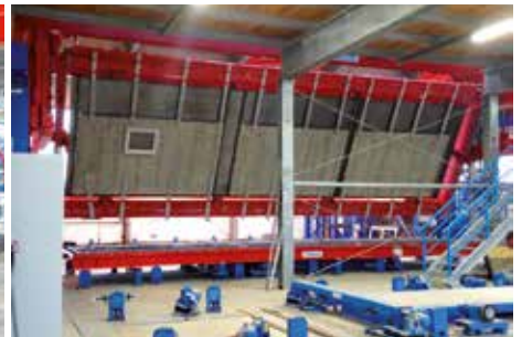
6. Verbinden der Innen- und Außenschale der Elementwand
